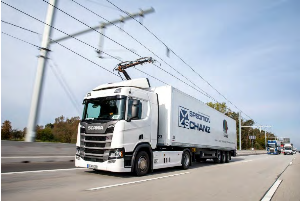
Abbildung 1: Oberleitungs-Lkw im Betrieb auf der ELISA-Teststrecke (A5 in Hessen). Quelle: Siemens 2019
