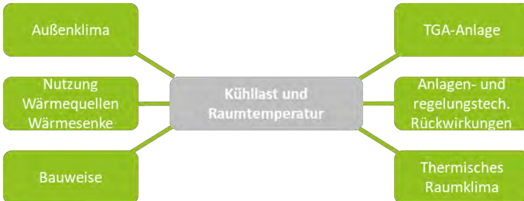
Abbildung 2-3: Einflussparameter auf Kühllast und Raumtemperatur nach VDI 2078
