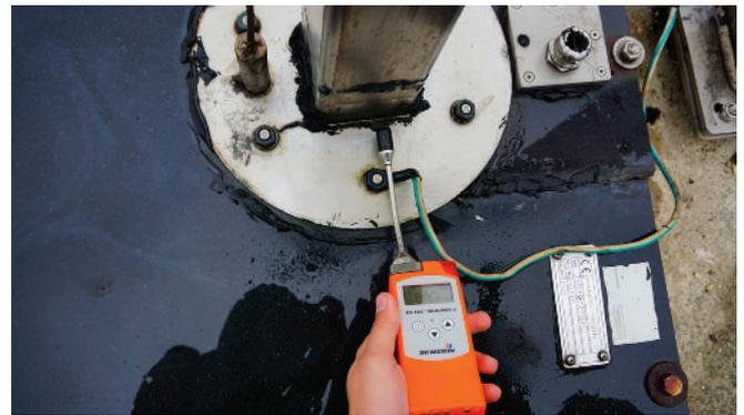
Detektion einer Gasleckage mittels Methanschnüffler an einer Überdrucksicherung
