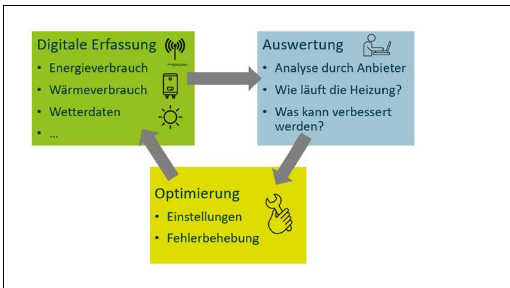
Abb. 8.2: Prinzip der digitalen Effizienz bzw. Betriebsüberwachung
