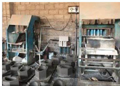
Wegen zu geringer Stromspannung muss die Bausteinproduktion bei Bemz oft manuell erfolgen. Solare Eigenstromerzeugung ist noch nicht wirtschaftlich.
