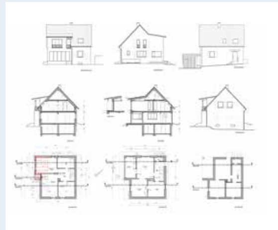
Abbildung 12: Digitales Aufmaß. Grafik: Digitaler Zwilling, Andreas Klingerbeck (links), manuell angefertigte Pläne, Gerd Bauer (rechts)
